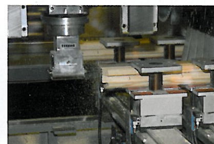
Det går så flisene fyker mens delene bearbeides inne i maskinen. Før de kommer ut igjen er delene både høvlet, tappet og boret, samt at det er gjort nødvendige beslagsutpressinger.
