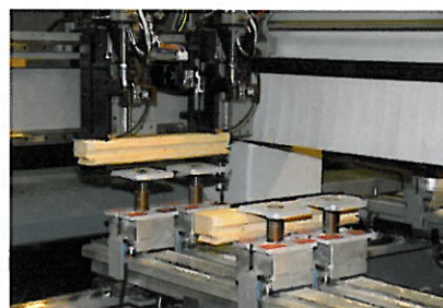
Innmatingstransportøren på Biesse Rover C WMS har griper på utleggsarmen og løfter delen rett inn i maskinen. Etter den komplette bearbeidingen bringer de samme griperne delen ut igjen – fiks ferdig.
